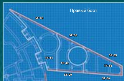
Указанные красным цветом номера соответствуют маркировке, нанесенной на рамы каркаса. Обратите внимание, что рамы TF-42 и TF-43 идентичны рамам BF-46 и BF-47, поэтому имеют двойную маркировку.
