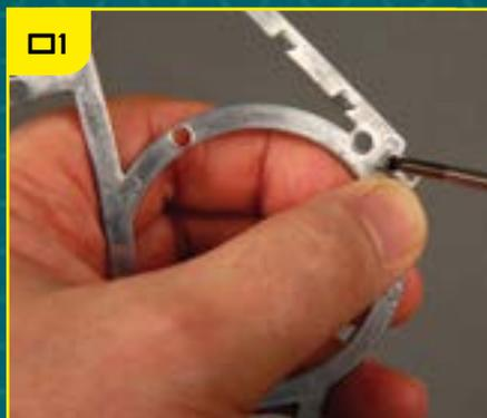
01 Закрепите соединительную накладку с двумя отверстиями на раме TF-41, как показано.
